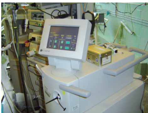
Foto 2. 60 W Ho: Yag laser.
