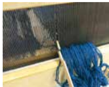
Foto 8. Lõimelõngade soastamine soasulase abil. Astri Kaljuse foto.
