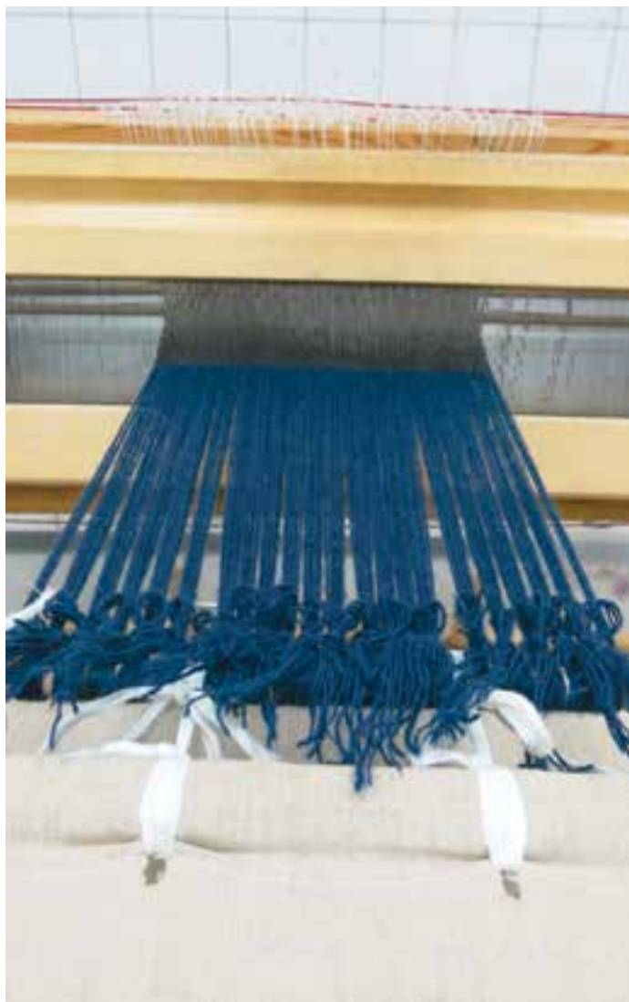
Foto 9. Lõimede ette sidumine kangapoomi külge. Astri Kaljuse foto.
