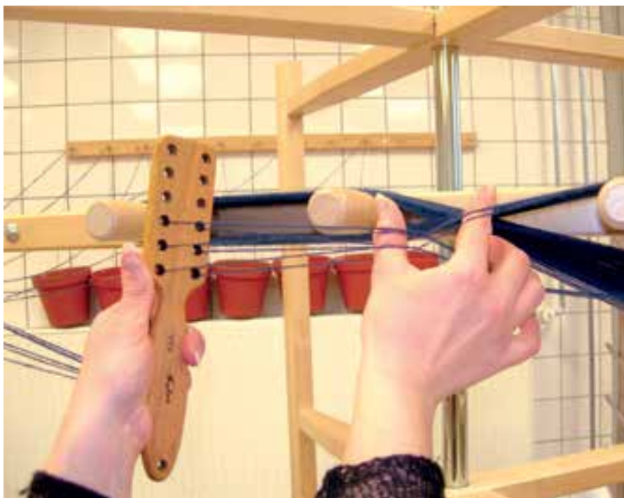
Foto 6. Käärlauaga lõimede käärimine. Astri Kaljuse foto.
