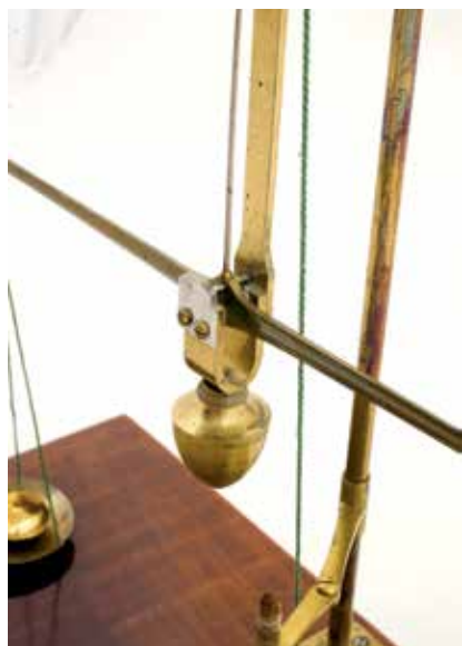
Foto 4. Kaalukangi laager tugisüsteemi laagrialustel (eestvaade). Paremal all võnkesummuti (foto A. Tennus)
