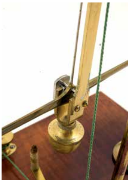
Foto 5. Kaalukangi laager tugisüsteemi laagrialustel (tagantvaade). Vasakul tõstenööri kerimisnupp (foto A. Tennus)
