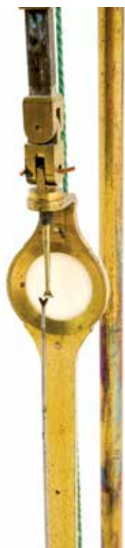
Foto 8. Kaalu tõstemehhanismi kaks, kaalu tasakaalustavat liidet, tugisüsteemi liitumispuks tõstemehhanismiga, dioptri nõel ja kaalu keele tipp (foto A. Tennus)
