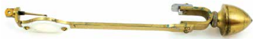
Foto 6. Kaalu tugisüsteem. Ülal tõstemehhanismiga ühenduslülili, allpool dioptri nõel ja piimklaasist tagune. All paremal terasest, rombikujuline kaalulaagri eespoolne, õnarusega alus (foto A. Tennus)
