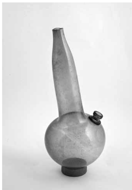
Foto 2. Rohelisest metsaklaasist tuubusega destilleerimiskolb, millele käib peale alembiik (A. Tennuse foto)
