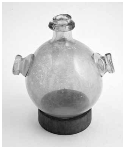
Foto 5. Kolme tuubusega paksust klaasist ümmargune vahepudel (A. Tennuse foto)
