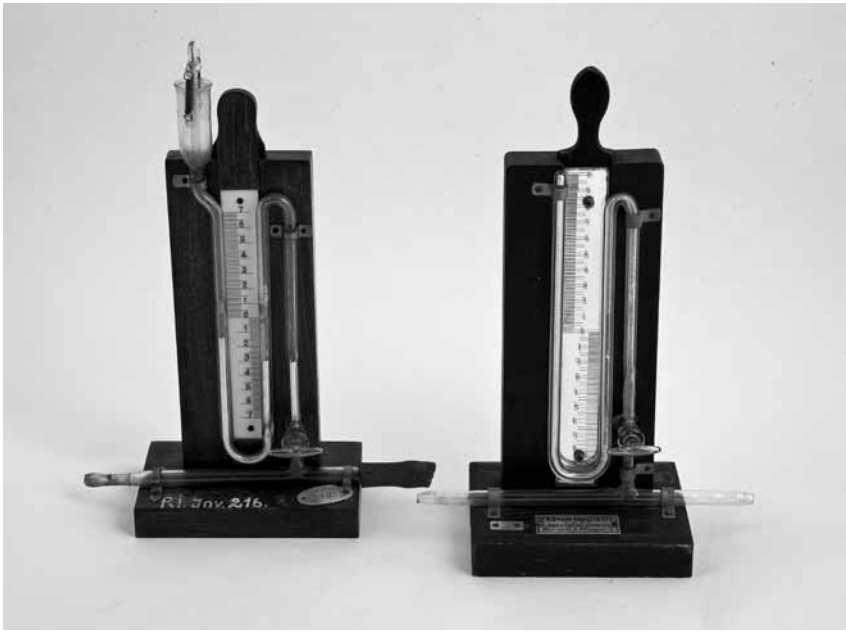
Foto 9. Bennerti elavhõbevaakummeetrid vaakumdestillatsiooni tarbeks. Firma Rohrbeck, Berlin (A. Tennuse foto)
