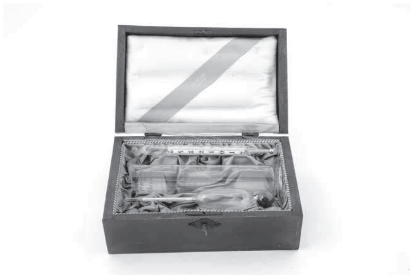
Foto 2. Laktodensimeeter. H. Kühn, Dorpat. 19. saj. Piima tiheduse mõõtmise vahend, et määrata selle rasvasust (ÜAM 1150:18 AjM)
