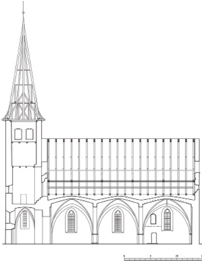
Abb. 5. Längsschnitt in Richtung Norden. Vermessen von Jaan und Enn Armolik 1943. Estnisches Historisches Archiv f. 2100, n. 18, s. 27
