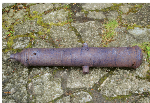
Fig. 4. The 15th-century 'tower cannon' of Haapsalu after heating and surface cleaning. Jn 4. Haapsalu 15. sajandi "tornisuurtükk" pärast "kuumutusravi" ja pinnapuhasust. Photo / Foto: Jüri Peets
