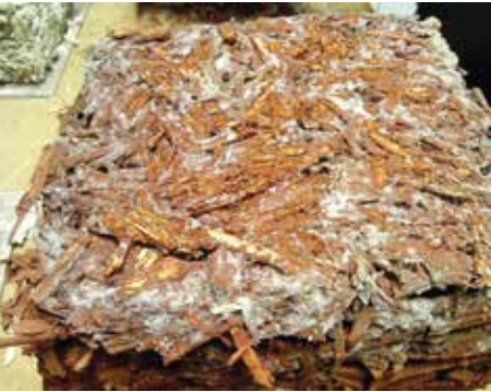
Foto 5. Hallitus savist ja kanepiluust valmistatud katseplokil. Markus Pau foto.
