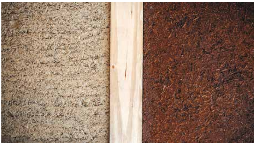
Foto 3. Haavapuidust sõrestikuga eraldatud kanepi-lubja ning kanepi-savi segu. Silver Tõnissoni foto.
