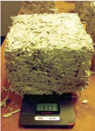
Foto 6. Kanepiluu ning õhklubja segust valmistatud katseplokk. Markus Pau foto.
