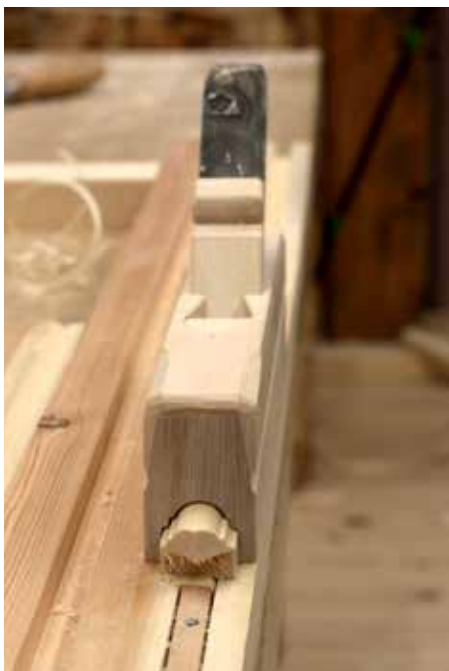
Foto 27. Stiklestad Rahvusliku Kultuurikeskuse profilhõõvli koopia kasutamine prosspulga ülaosa profileerimiseks. Prosspulk kinnitatakse punniga liistulaua soonde ning liistulaud toimib hõõvlile sügavuspiirajana, kuna hõõvli kehand toetub laua pinnale. Foto Thor-Aage K. Heiberg, 28. märts 2025.
