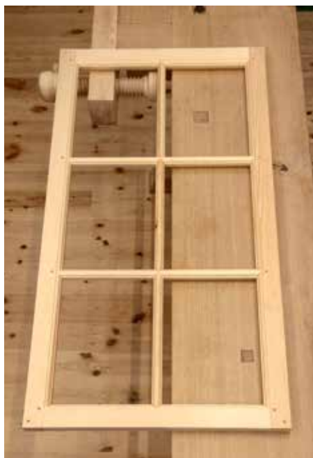
Fotod 30 ja 31. Üks aknaraam, mille me oma eksperimentide käigus valmistasime, märgistades kõik tappseotised enne profileerimist. Valmistasime ka ühe väiksema nurgaseotise, et testida prosspulkade hõõveldamise eri viise. Nurk on tehtud õppeotstarbel ja seda saab lahti võtta, niisiis on see foto jaoks kokku pandud. Foto Thor-Aage K. Heiberg, 28. märts 2025.
