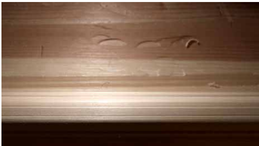
Foto 25. Valmis prosspulk pärast lameda osa maha hõõveldamist, kus on näha sarnaseid tööriistajälgi, nagu me leidsime vanadelt Stiftsgårdeni akendelt. Foto on tehtud külvalgusega, et peaaegu nähtamatuid jooni paremini esile tuua. Foto Thor-Aage K. Heiberg, 26. märts 2025.
