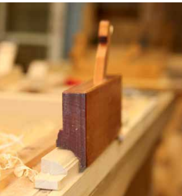
Fotod 21 ja 22. Prosspulga ristlõike esimese ja teise veerandi vormimine ilma hõõvli sügavuspiirajat kasutamata. Fotod Thor-Aage K. Heiberg.
