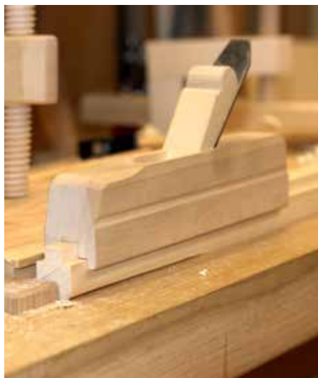
Foto 26. Punnhõõvel kujundab üheaegselt mõlemad klaasivaltsid. Foto Thor-Aage K. Heiberg, 25. märts 2025.
