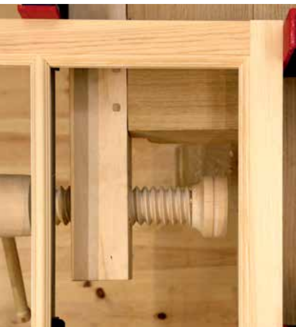
Fotod 30 ja 31. Üks aknaraam, mille me oma eksperimentide käigus valmistasime, märgistades kõik tappseotised enne profileerimist. Valmistasime ka ühe väiksema nurgaseotise, et testida prosspulkade hõõveldamise eri viise. Nurk on tehtud õppeotstarbel ja seda saab lahti võtta, niisiis on see foto jaoks kokku pandud. Foto Thor-Aage K. Heiberg, 28. märts 2025.
