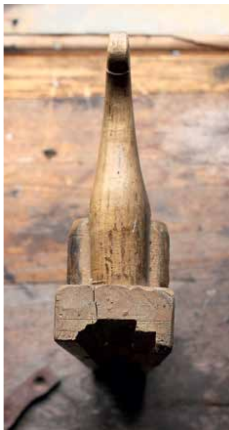
Foto 16. Litjholtgjerdetist Meldali vabaõhumuuseumist leitud hõövel, millega saab hõõveldada akna raampuid ja prosspulki külje pealt.
