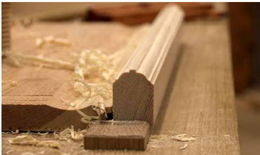
Foto 24. Siin jäljendasime seda, kuidas kasutada hõõvliit nõnda, et mitte lõigata prosspulga keskteljeni, jättes hõõvli sügavuspiirajale lameda ülariba. Foto Thor-Aage K. Heiberg, 26. märts 2025.
