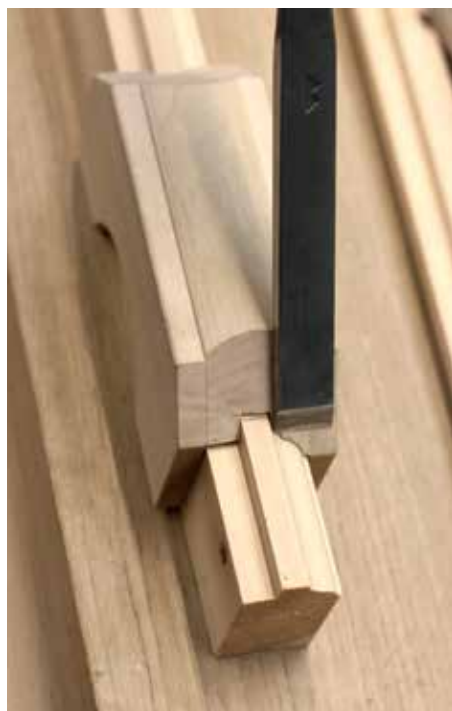
Foto 20. Juhik, mis aitab hoida ühtlast kõrgust raampuude ja prosspulkade profileerimisel. Seda kasutatakse ka liitekohtades profiili servade nurga alla löikamiseks. Juhik asetatakse sisemise laiuse või kõrguse (SLK) alusel. Foto Thor-Aage K. Heiberg, 25.märts 2025.
