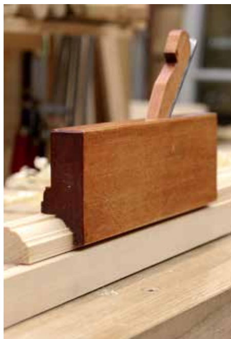
Foto 23. Prosspulga ristlõike esimese neljandiku hõõveldamine, kasutades hõõvli sügavuspiirajat, mis tagab puu õige kõrguse. Teine neljandik nagu fotol 21. Foto Thor-Aage K. Heiberg, 9. aprill 2025.
