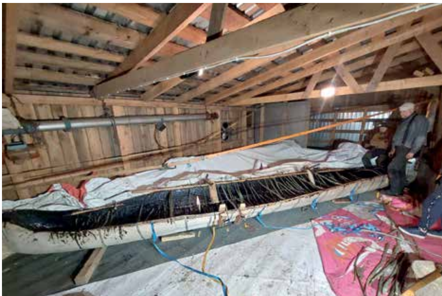
Foto 21. Umbes 7 meetri pikkune Matsalu tüüpi ühepuuvene on laotatud. Foto Allan Jürgens, 2024.
