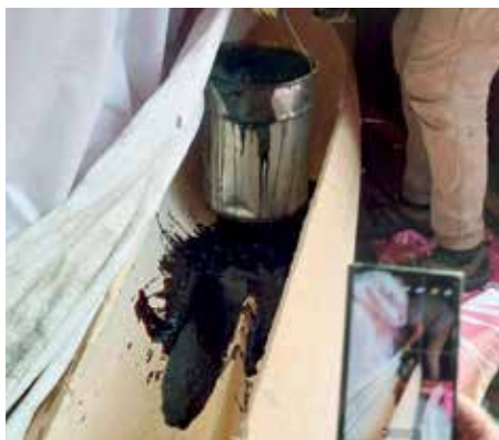
Foto 17. Vee asemel kasutame ühepuuvene laotamiseks kuuma männitõrva. Foto Allan Jürgens, 2024.
