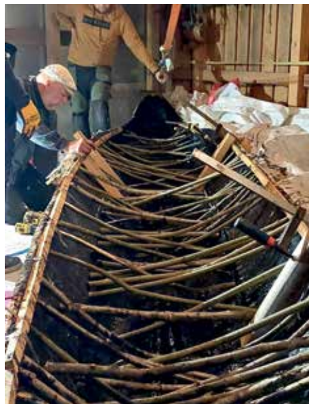
Foto 22. Laotamine on lõppenud, parraste laiuks on umbes 105 cm. Foto Allan Jürgens, 2024.
