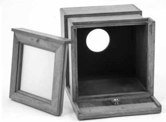
Foto 9. Fotokaamera sisevaade. Vasakul kaamera tagaküljelt välja tõstetud mattklaasiga raam. Ees pidurikruvi lai pea (Andres Tennuse foto).
