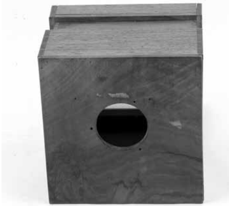
Foto 7. Fotokaamera eestvaade. Näha objektiivivi kolme kinnituskruvi jäljed (Andres Tennuse foto).
