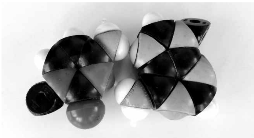
Foto 2. Mittestandardse lämmastikaluspaari tsütosiin-adeniin (C-A) ruumitäitev atomaar-molekulaarne mudel, mis on koostatud Raik-Hiio Mikelsaare idee alusel 1980. aastatel (Ado Jaagosilla juhitud) Tartu Riikliku Ülikooli eksperimentaaltöökogas toodetud Tartu plastist aatomimudelitest. Just selle aluspaari ehituse ja rolli selgitamine viis 1970. aastate lõpus mõttele luua Tartus senistest paremad atomaar-molekulaarsed mudelid. Tsütosiin (C) on kujutatud vasakul ja adeniin (A) trans-asendis paremal ning nende vahel on imiteeritud vesiniksidemeid -NH...N- ja -N...HN-.
