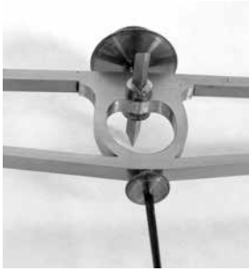
Foto 5. Kaalkangi kesk-osa koos terasprisma ja selle kinnitusmuhviga
