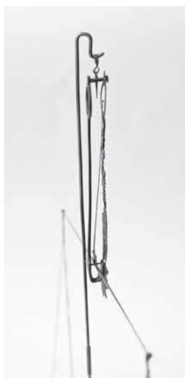
Foto 5. Kaaluõlgade tugiosa külgsaade (foto A. Tennus)
