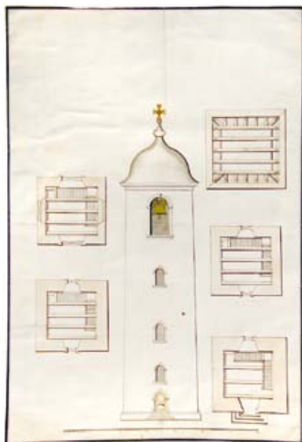
Abb. 21. Narva. Aufriss und Grundriss des Glockenturms in Narwa (1733). RGADA, fond 248, opis' 160, delo 1407.
