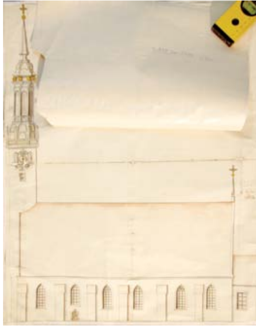
Abb. 19. Narva. Aufriss der Preobraženskij-Kirche in Narwa mit zwei Varianten des Projekts des hölzernen Glockenturms auf dem Dach (1733). Erstellt vom Brücken- und Mühlenbaumeister Johann Nikolaus Schini. RGADA, fond 248, opis' 160, delo 1406.
