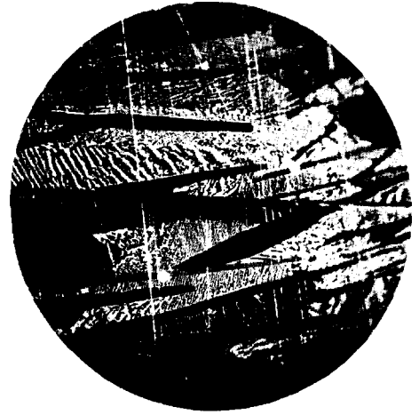
Fig. 2. 40 At% Ag. Vergr. 75 \times .
