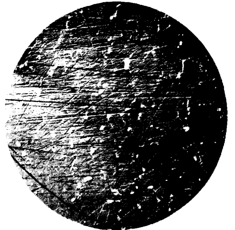
Fig. 4. 68 At% Ag. Vergr. 75 \times . Abgeschreckt.
